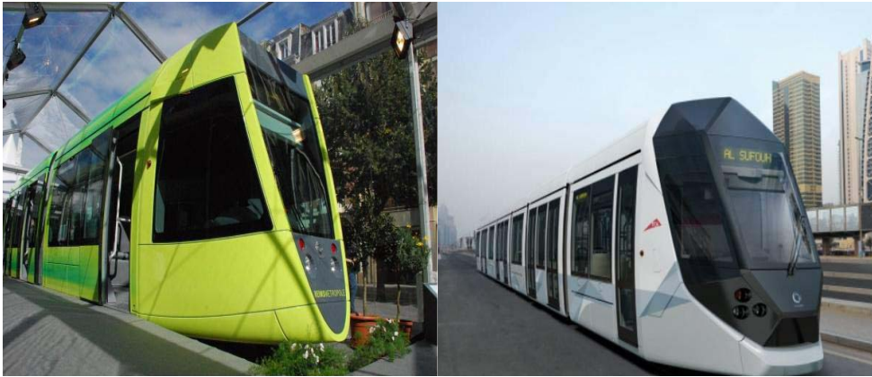
法國，藍斯（Reims），無架空線系統 杜拜（Dubai），無架空線系統
