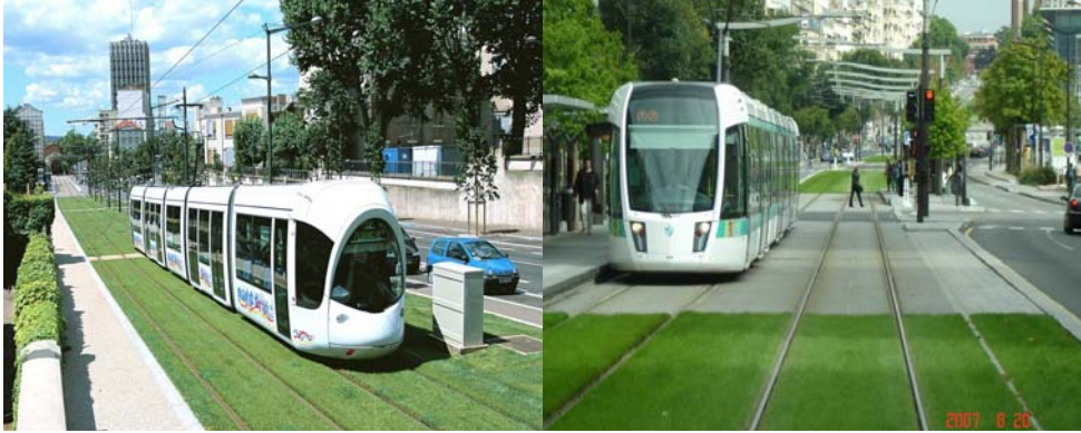
法國，里昂（Lyon），軌道植草綠化 法國，巴黎（Paris），軌道植草綠化
