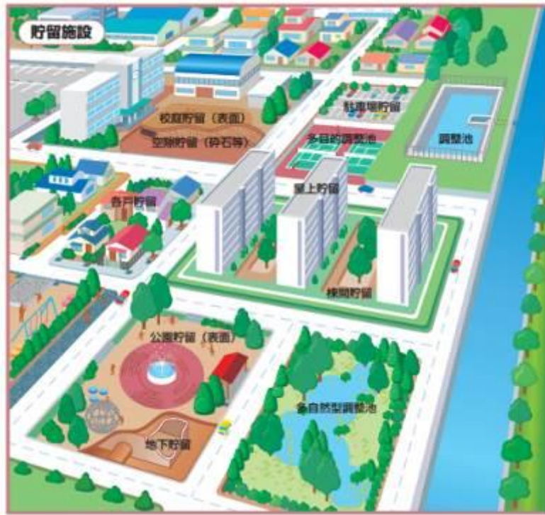
圖 4 運用運動場、操場等公共空間進行小型滯洪範例
