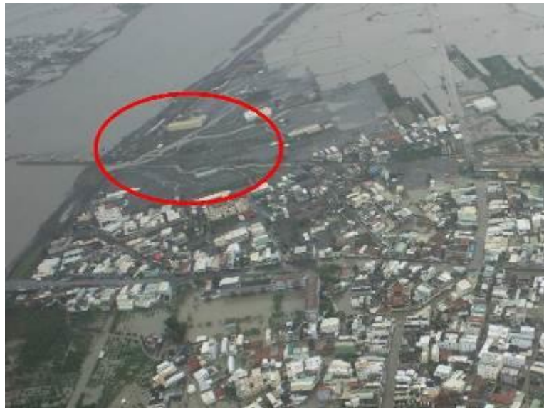
照片 7 林邊溪右岸潰堤及土砂淤積主要影響處 (水利署 3 , 2009)
