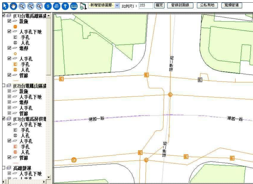
圖八 管線單位進行人手孔下地或提昇之屬性更新
