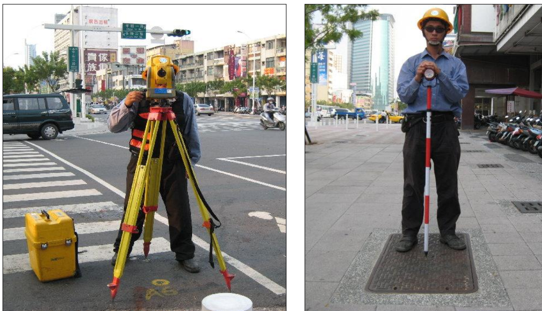
圖一 測量員進行外業孔蓋測量
