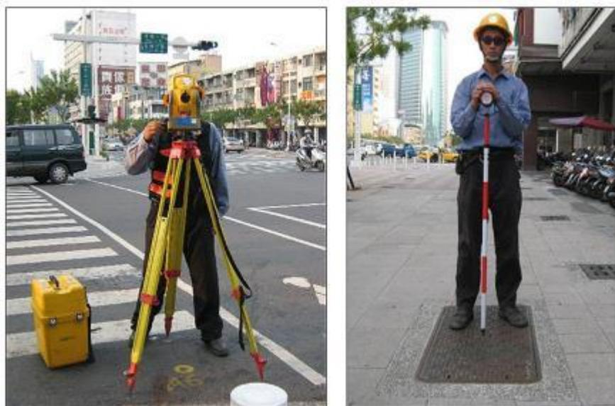
圖 9 測量員進行外業孔蓋測量
