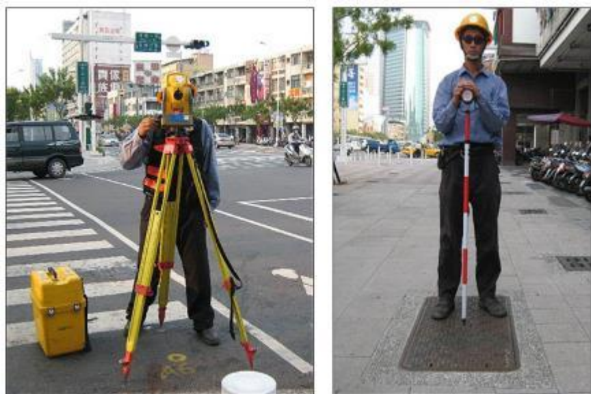
圖 9 測量員進行外業孔蓋測量
